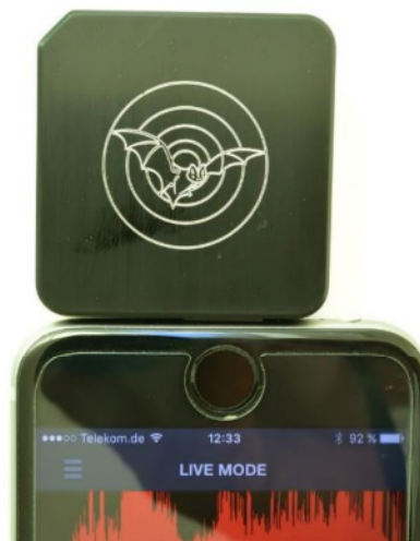
Abbildung 4: Ultraschallerweiterung Echo Meter Touch 2 (abgebildet ist die alte Version) für iPhone [Foto: J. Tauchert BG Natur].
