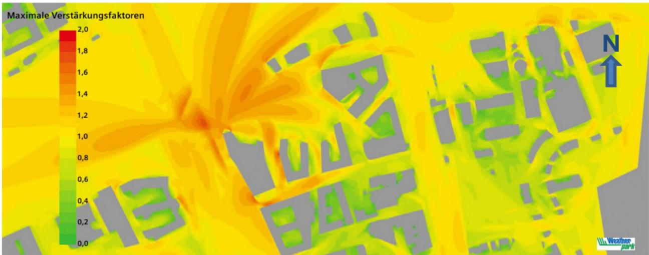
Abb. 5.6: Draufsicht Hochhausprojekt Kaiserleistraße mit Schnitt in 1,7m über Fußgängerniveau im **Planstand**. Farbflächen der maximalen Verstärkungsfaktoren aus 16 Windrichtungen.
