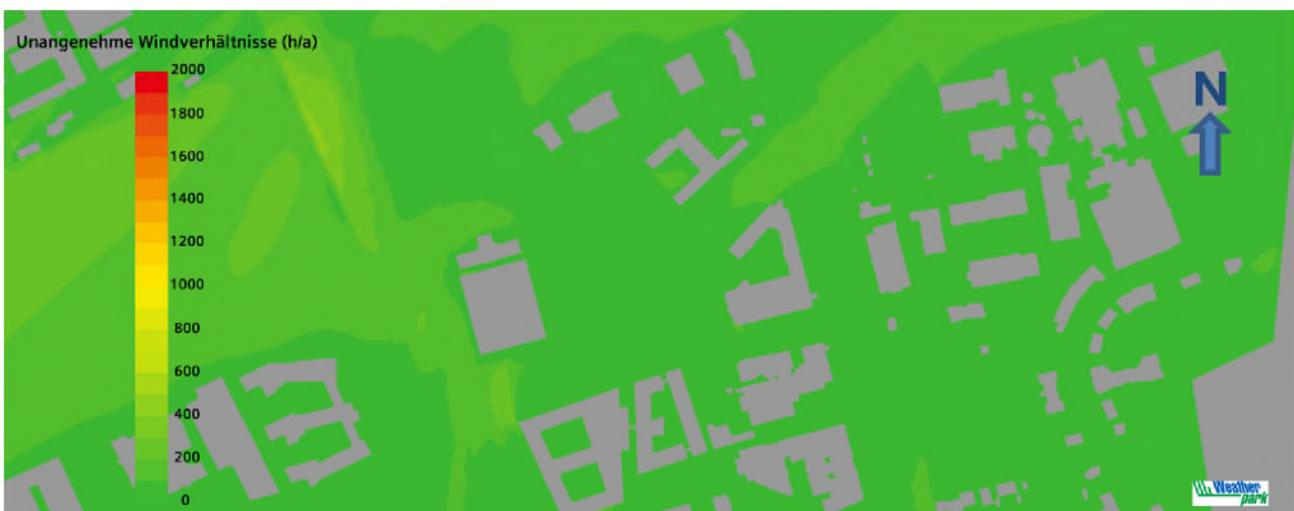
Abb. 5.1: Draufsicht Hochhausprojekt Kaiserleistraße mit Schnitt in 1,7m über Fußgängerniveau im *Ist-Zustand*. Farbflächen der Summe der unangenehmen Windverhältnissen über 16 Windrichtungen in Stunden pro Jahr für *kurzes Verweilen* im Freien.
