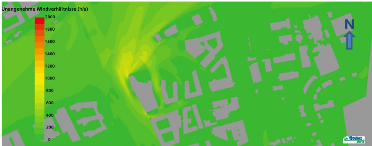
Abb. 5.2: Draufsicht Hochhausprojekt Kaiserleistraße mit Schnitt in 1,7m über Fußgängerniveau im *Planstand*. Farbflächen der Summe der unangenehmen Windverhältnissen über 16 Windrichtungen in Stunden pro Jahr für *kurzes Verweilen* im Freien.
