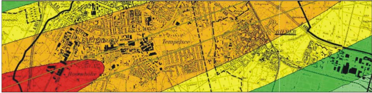
Abb. 3 Dauerschallpegel Ist – Westbetrieb – Tag (Quelle: RDF)
