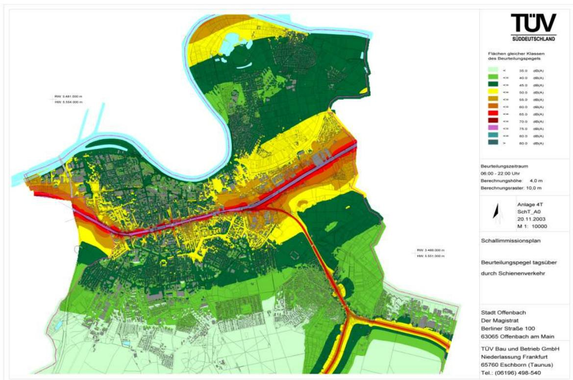
**Bild 9-4:** Schallimmissionsplan Schienenverkehr tagsüber [29]
