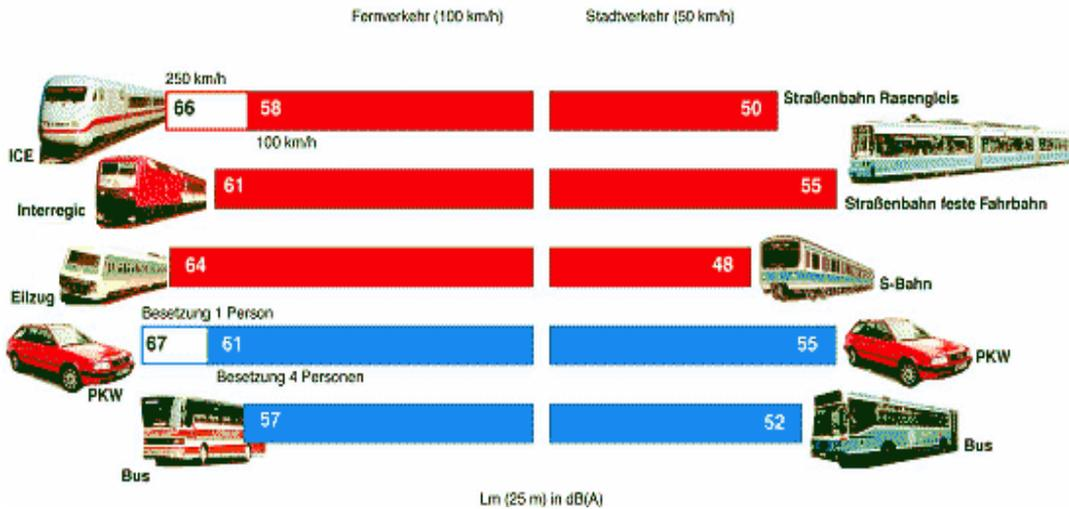
**Bild 8-2:** Spezifische Schallemissionen von Personenverkehrsmitteln, bezogen auf eine Transportkapazität von 1.000 Personen pro Stunde [2]
