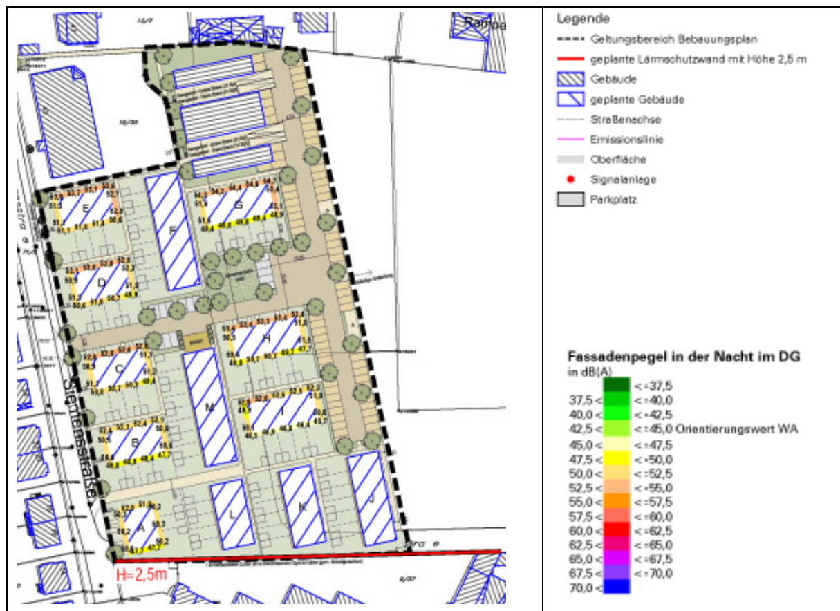
Abbildung 6: Verkehrslärm im Plangebiet: Beurteilungspegel an den Fassaden der vorgesehenen Gebäude im DG nachts, mit aktivem Schallschutz 4
