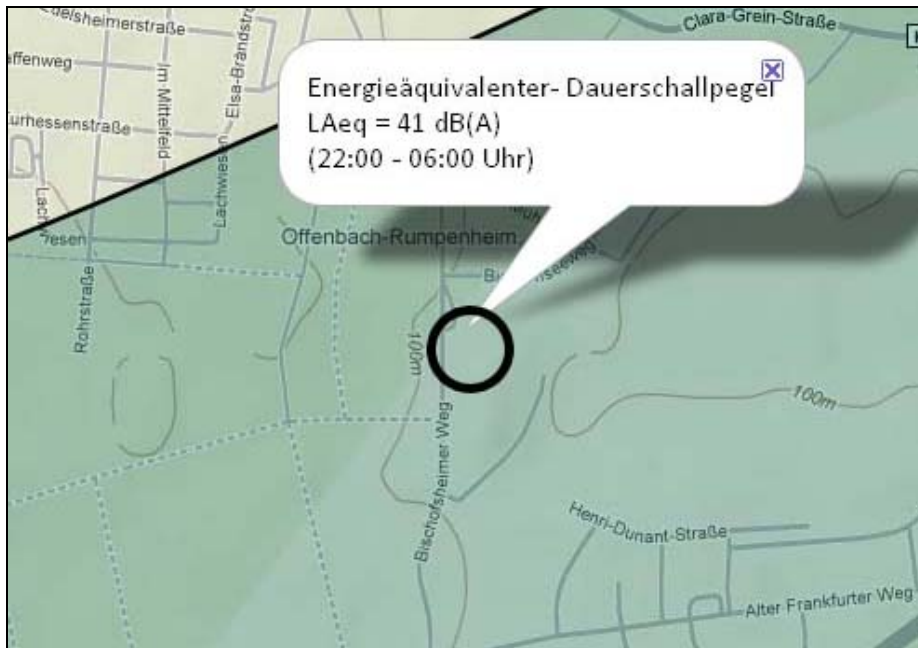
Abbildung 12: Ausschnitt aus der Darstellung der äquivalenten Dauerschallpegel bei Betriebsrichtung West in der Nacht (o.M.)
