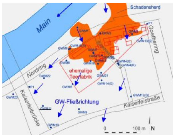
Abbildung 28: Schadensherd der Verunreinigung nördlich des Plangebiets und Fließrichtung Grundwasser (Quelle: Prof. Quick und Kollegen Ingenieure und Geologen GmbH, 2016)
