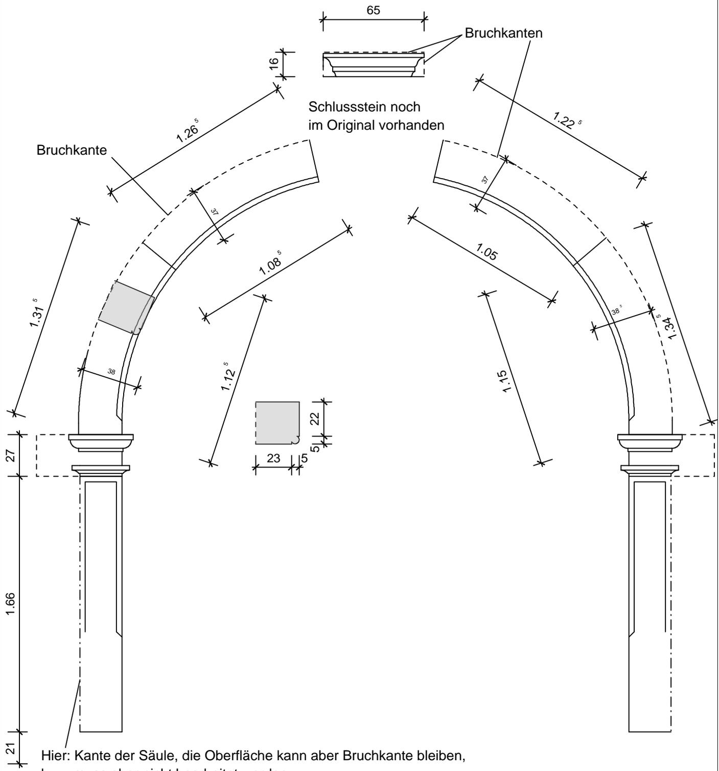
Hier: Kante der Säule, die Oberfläche kann aber Bruchkante bleiben, bzw. muss aber nicht bearbeitet werden.
