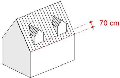
Damit das Dach in seiner Geschlossenheit weiterhin erkennbar bleibt, sind Gauben gegenüber der aufgehenden Fassade um mindestens 70 cm in Dachneigungsrichtung zurückzusetzen.
