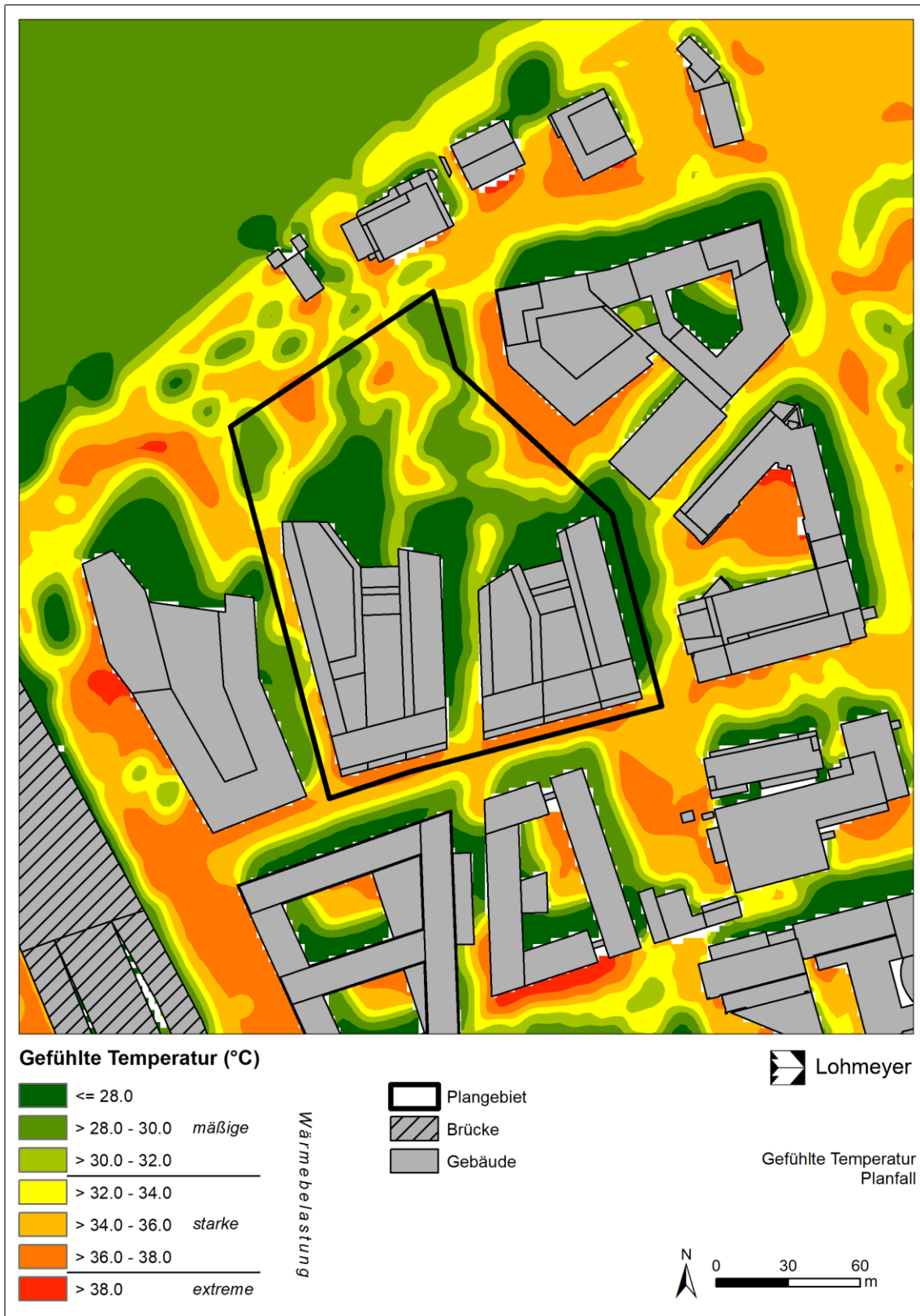
Abb. 7.12: Gefühlte Temperatur und zugehörige Wärmebelastungsklassen im Tageszeitraum für den Planfall
