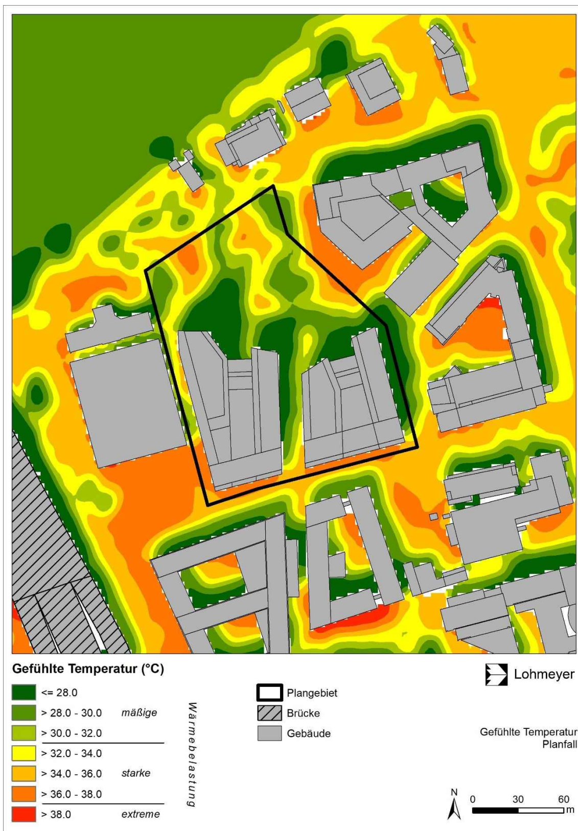
Abb. 7.4: Gefühlte Temperatur und zugehörige Wärmebelastungsklassen im Tageszeitraum für den Planfall
