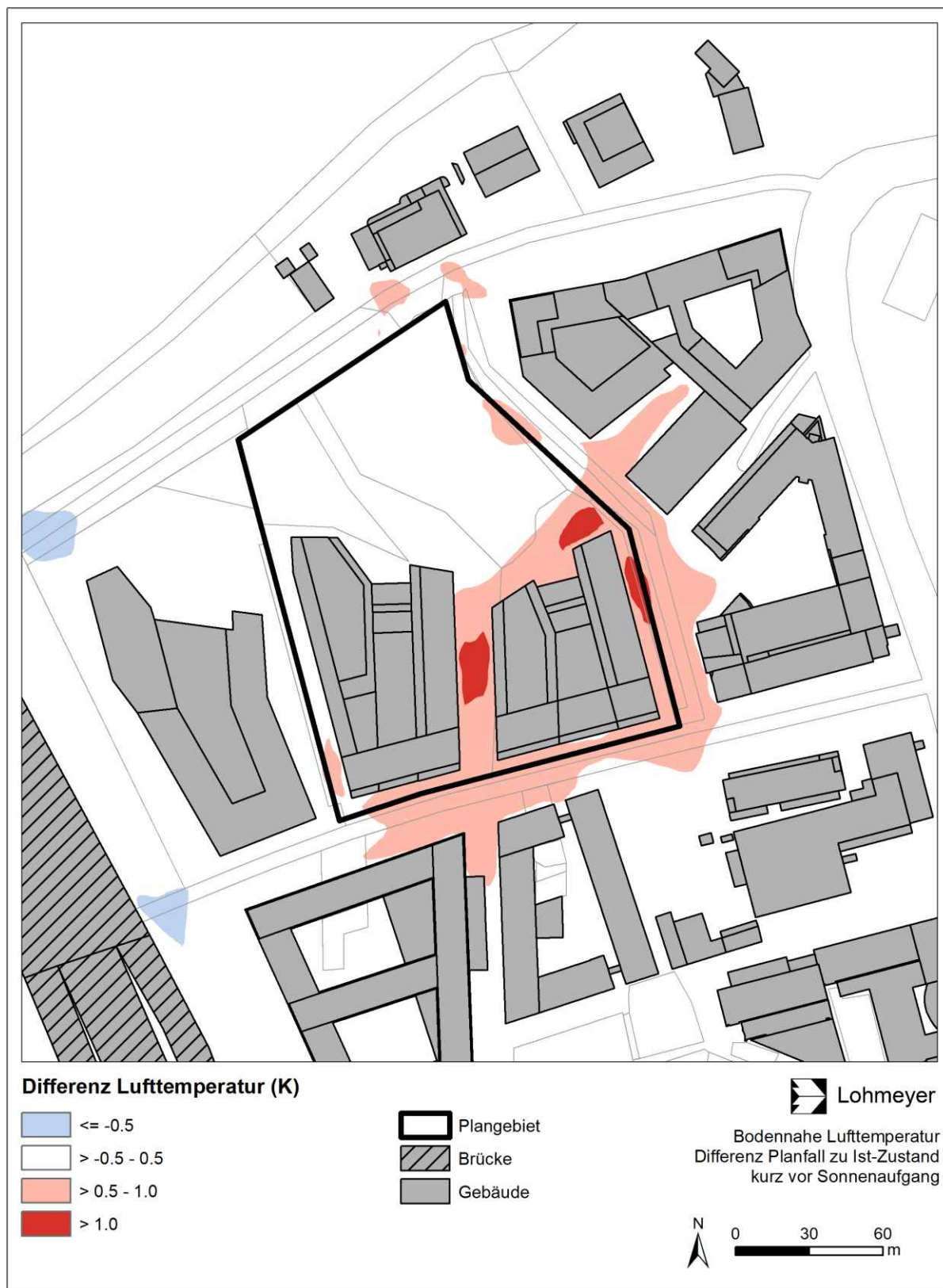
Abb. 7.16: Differenz der bodennahen Lufttemperatur im Nachtzeitraum
