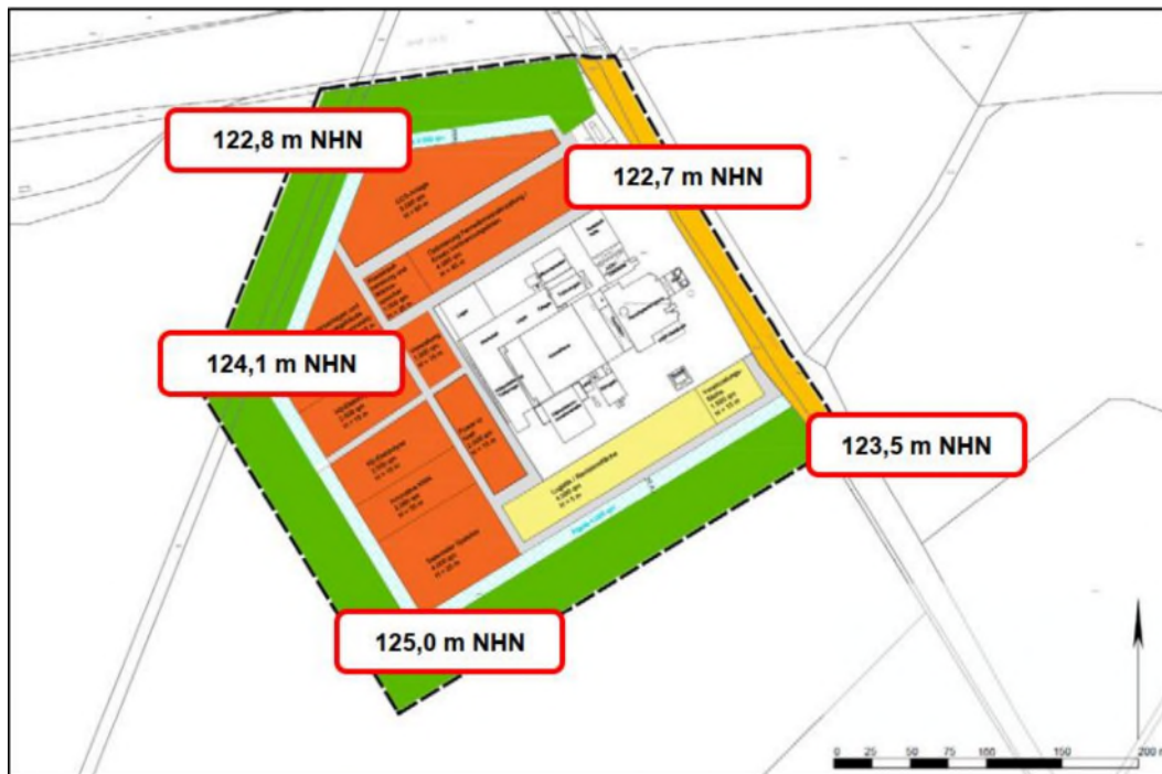
Abbildung 5: Vorläufige mittlere höchste Grundwasserstände für Versickerungsmaßnahmen [U 4]
