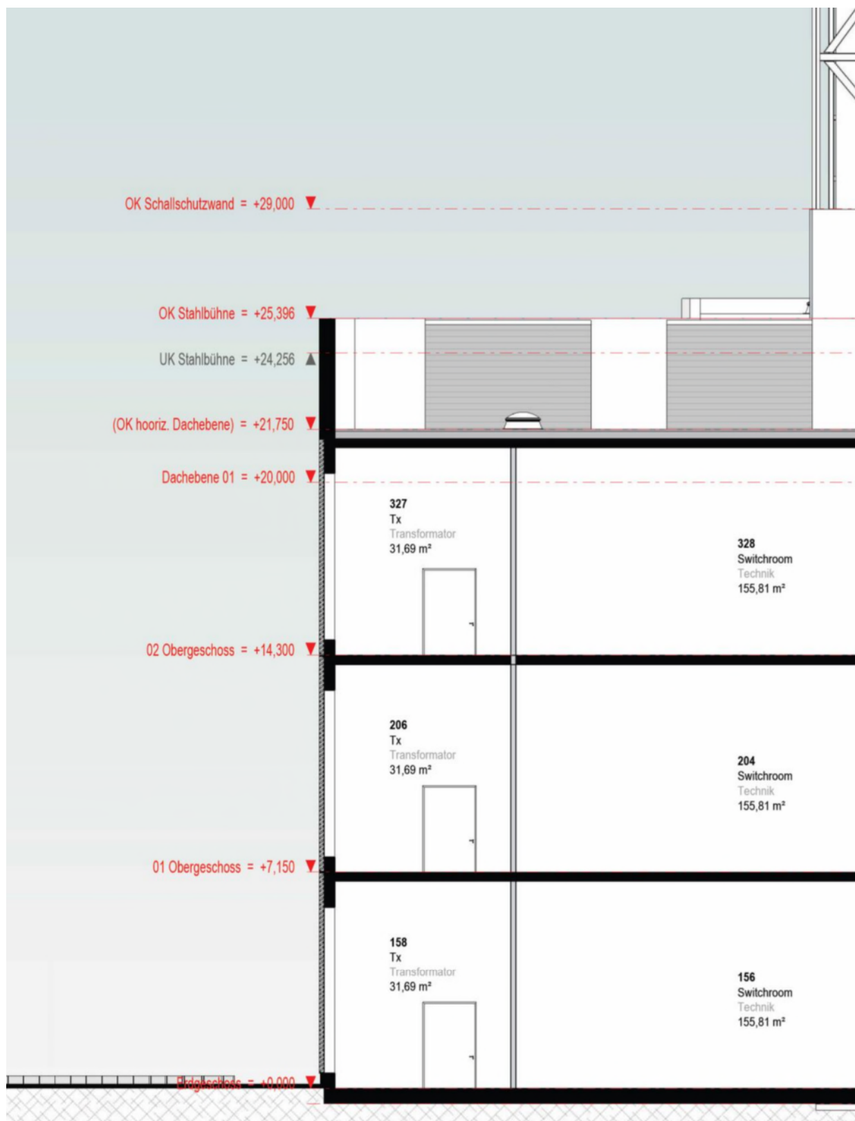
Abbildung 3.5: Schnitt durch das Rechenzentrumsgebäude - Ausschnitt (Quelle: Planungsbüro).
