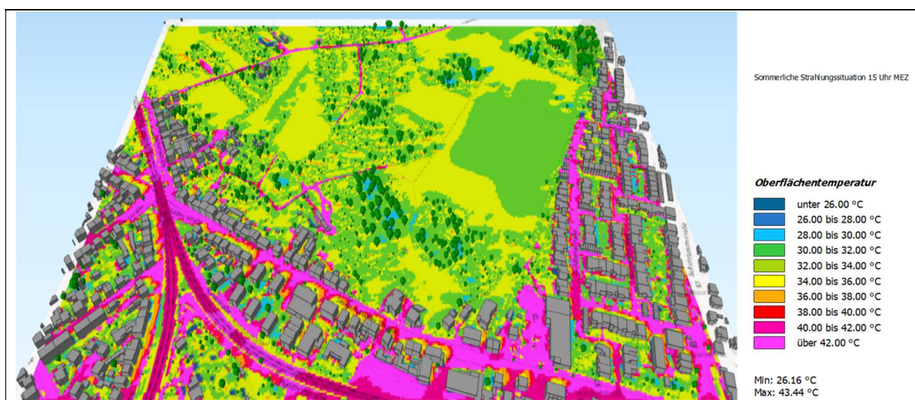
Abb. 21 Ergebnis der Berechnungen für die mikroklimatische Situation im IST-Zustand: Oberflächentemperaturen um 15 Uhr
