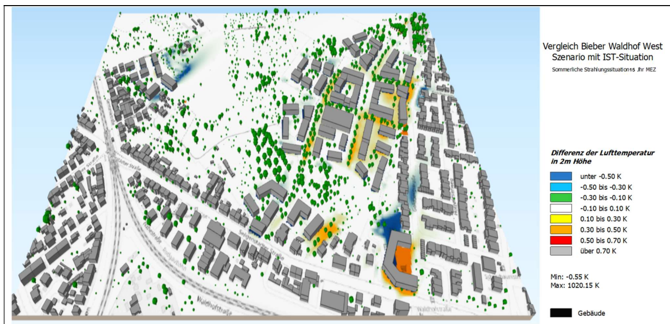
Abb. 17 Differenzen Plan-Szenario minus IST-Zustand: Lufttemperaturen um 15 Uhr in 2 m Höhe
