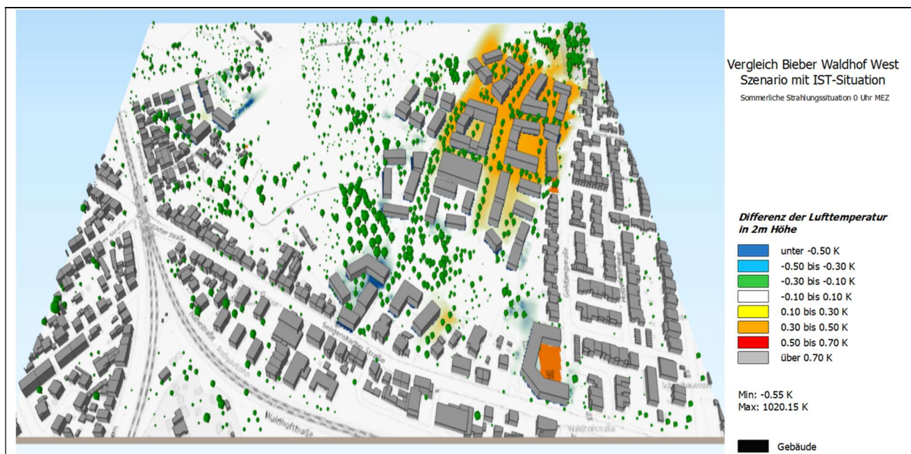
Abb. 20 Differenzen Plan-Szenario minus IST-Zustand: Lufttemperaturen um 0 Uhr in 2 m Höhe
