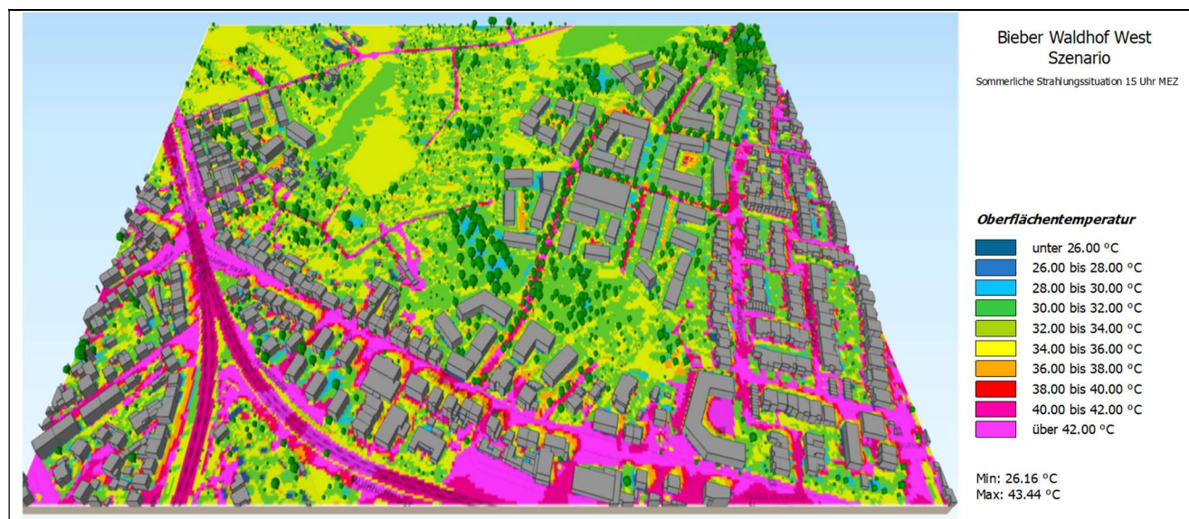
Abb. 22 Ergebnis der Berechnungen für die mikroklimatische Situation im Plan-Szenario: Oberflächentemperaturen um 15 Uhr
