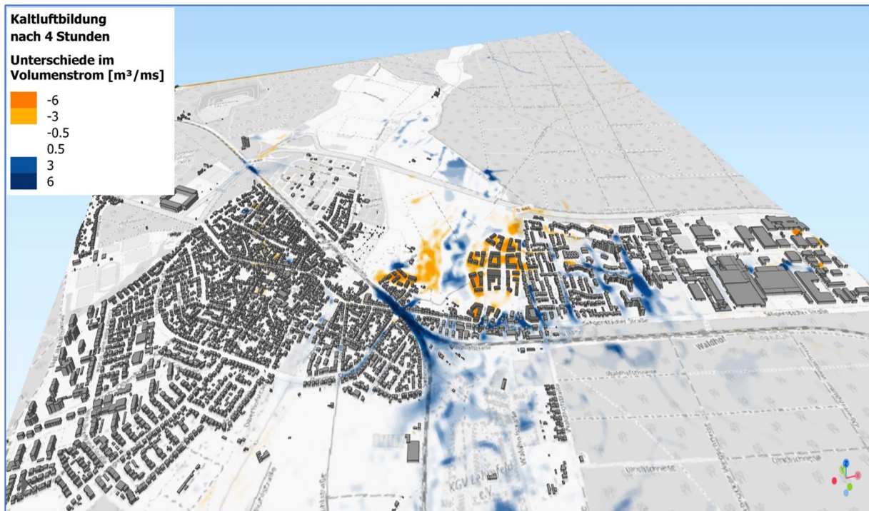
Abb. 11 Vergleich der Ergebnisse der Kaltluftsimulation für das Untersuchungsgebiet Bieber Waldhof West: Volumenstrom Plan-Szenario minus IST-Zustand 4 Stunden nach Sonnenuntergang
