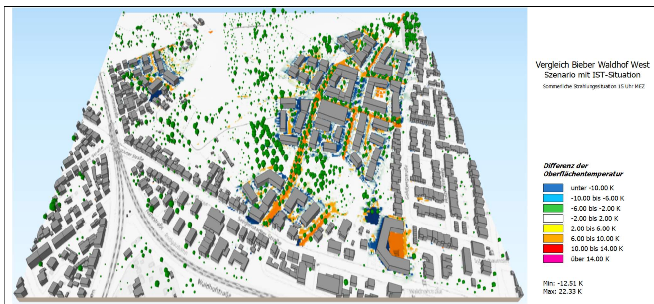
Abb. 23 Differenzen Plan-Szenario minus IST-Zustand: Oberflächentemperaturen um 15 Uhr
